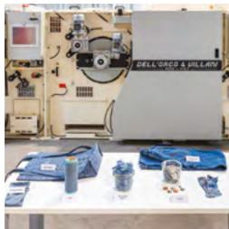
Le CETIA réunit pour la première fois les ouvreuses et le système CLEANING WILLOW de DELL'ORCO Y VILLANI, qui permet de séparer mécaniquement les fibres et les points durs des vêtements (boutons, fermetures à glissières, coutures...) afin de récupérer en sortie de la fibre prête à être valorisée.
