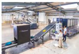
La machine de tri textile Fibersoft de Valvan, utilise l'IA pour identifier et séparer les textiles en fonction de la composition des fibres et des propriétés de la couleur.
