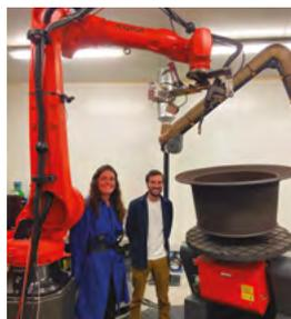
CERTIM, PME installée sur la technopole Izarbel a été lauréate de l'appel à projet éco-innovation de la Communauté Pays basque pour le projet WAAMOLD, mené en partenariat avec Addimadour. Ce projet a pour objet la réalisation d'outillage en fabrication additive afin de réduire la quantité de matière première utilisée.
